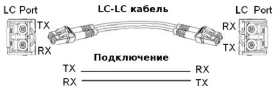
Рис. 9. Подключение оптического кабеля к оптическому трансиверу
